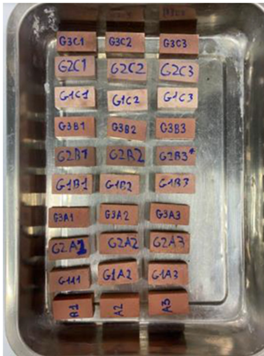
Figura 2. Ensaios no ISE da Universidade do Algarve para incorporação de lamas de ETA na aplicação em cerâmica.
