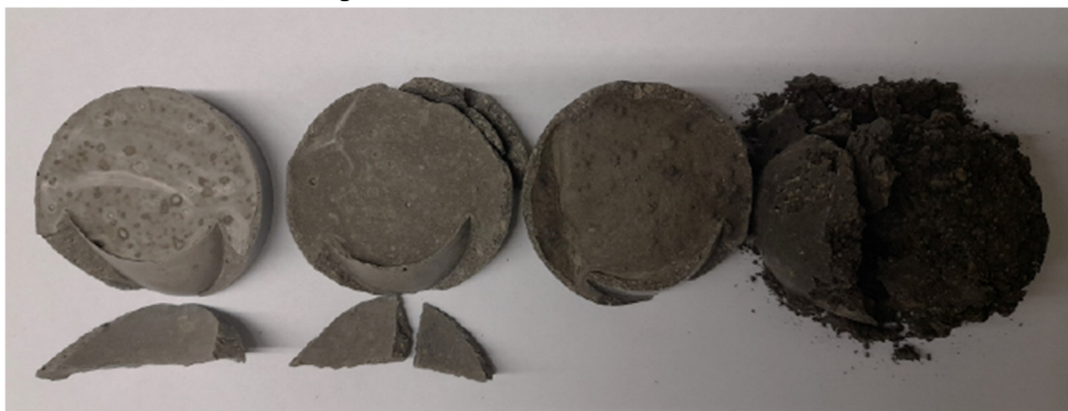
Figura 1. Ensaio no ISE da Universidade do Algarve para incorporação de lamas de ETA na aplicação em compósitos cimentícios.
